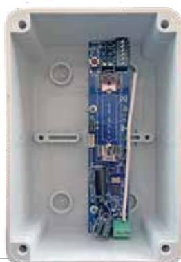
**ACG6202B TRASMETTITORE RADIO RED 2.0** per costa meccanica o elettrica 8,2KΩ - da alimentare con una batteria lithio AA da 3,6V non inclusa
